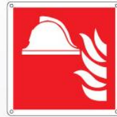
Attrezzature antincendio F004
